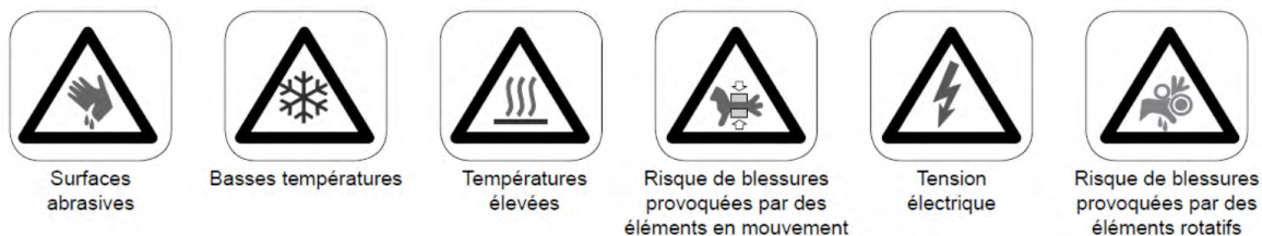
FIGURE 13 : Exemples de pictogrammes ou symboles de danger en application de la directive Machines
